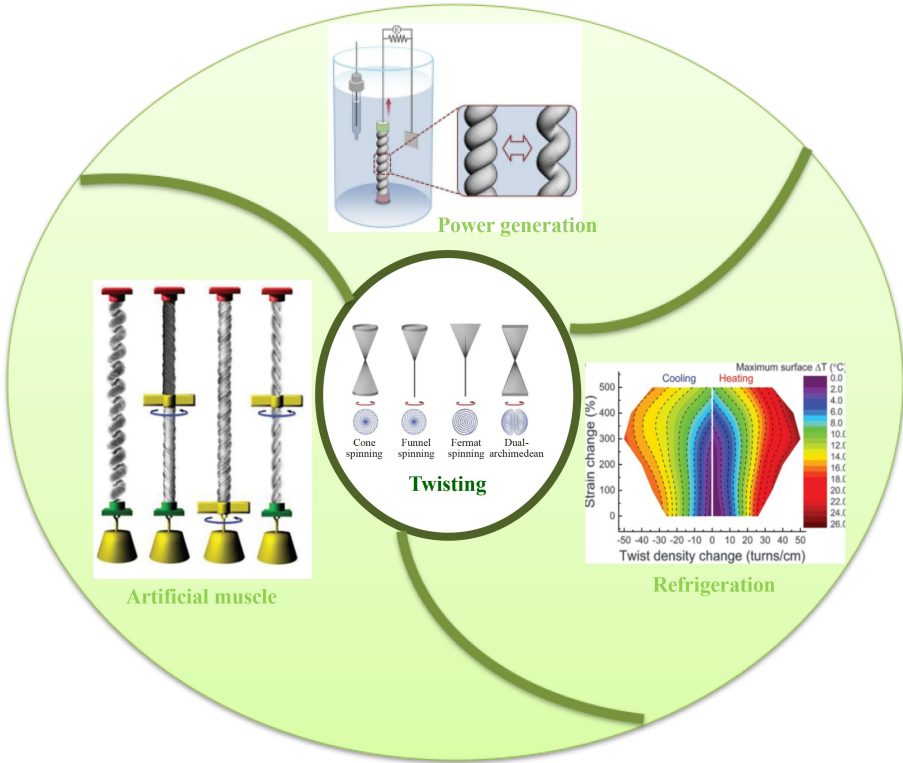
图 1 纤维加捻的方法及应用 [6~8] (2019, 2017, 2012 The American Association for the Advancement of Science 版权许可)
